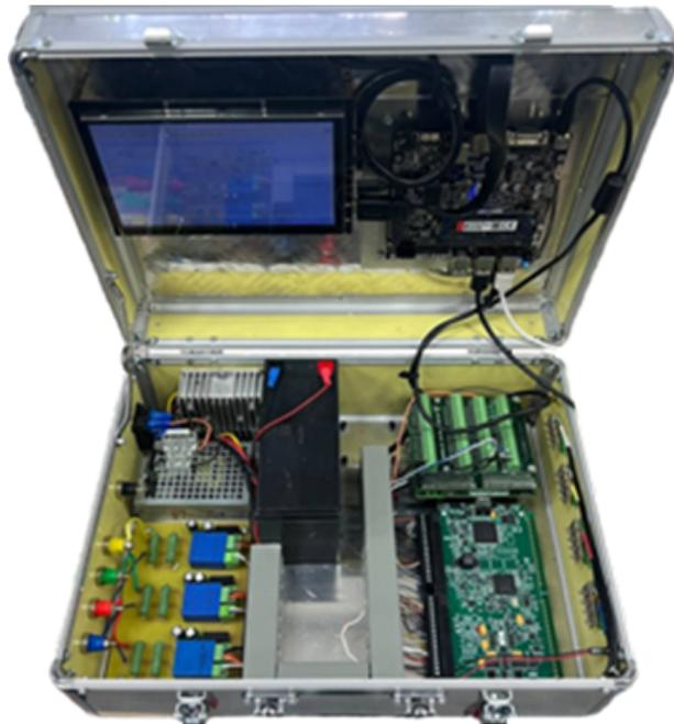
Рисунок 1.5 – Система регистрации и измерения территориально-распределённых и удалённых электроустановок и сетей
