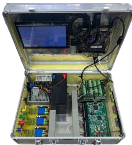
Рисунок 1.5 – Система регистрации и измерения территориально-распределённых и удалённых электроустановок и сетей
