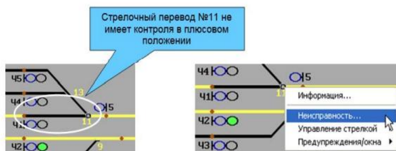
Рис.27. Фрагмент пульт-табло станции при неисправности стрелочного перевода.
